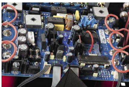
Górna, wyeksponowana płytka zawiera tylko elementy zasilacza układu sterowania.
